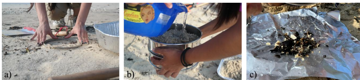
Figura 2. Recolección de muestra: a) hundimiento del muestreador, b) reducción de volumen, c) resguardo de la muestra
