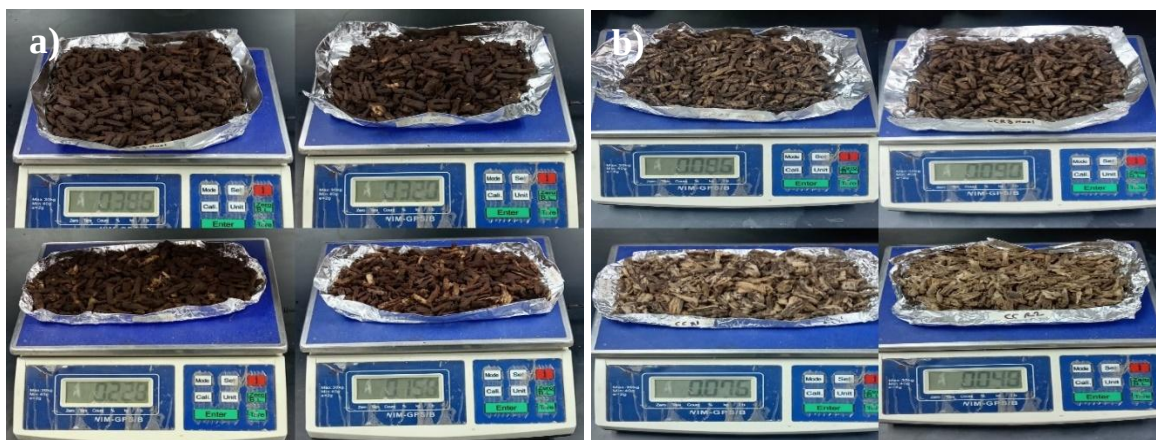
Figura 6. Determinación de a) masa húmeda y b) masa seca de las CC composteadas
