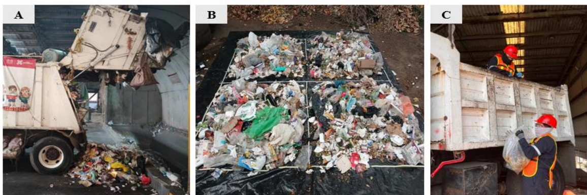
Figura 2. Obtención de la muestra representativa. A) Descarga de los residuos para toma de premuestra. B) Aplicación del método cuarteo para la obtención de la muestra representativa. C) Toma de muestra de orgánicos el martes
