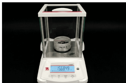
Figura 3. Determinación de humedad
