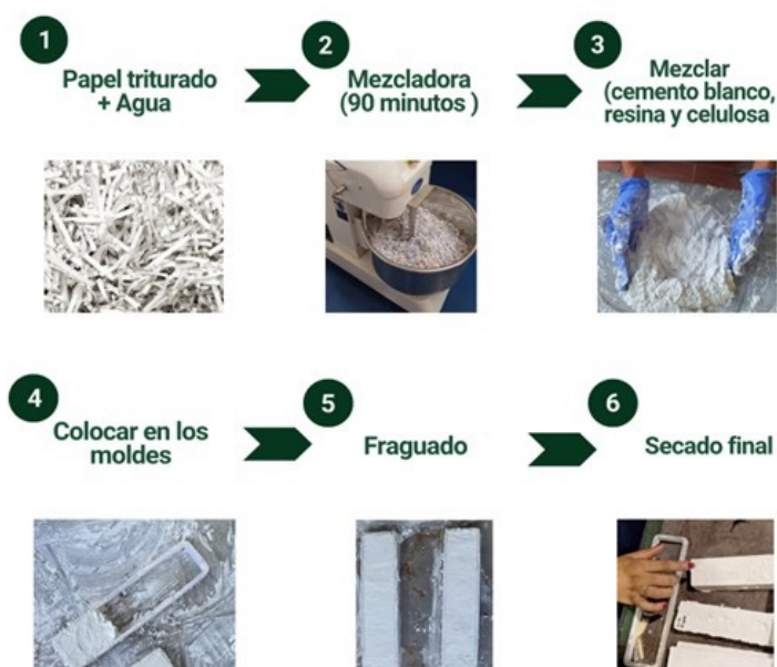
Figura 1. Preparación de ladrillos.
