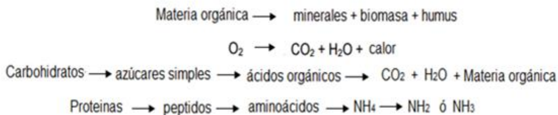
Figura 1.1 Reacciones bioquímicas en el compostaje.
