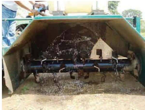
Figura 3. 16 Máquina volteadora de material con adición de agua. Fuente: Cifuentes, de León y Porres, 2011.
