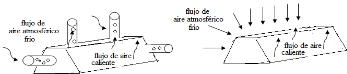
Figura 1.9 Pila estática con aireación pasiva.
