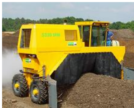
Figura 3. 14 Ejemplos de equipo para airear pilas durante el composteo. Fuente: a) COMPOSTAMEX , 2016; b) PEZZOLATO, 2016; c) RECOVERY. (2016).
