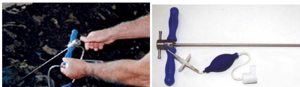
Figura 3.7 Oxímetro para composta con sonda de aspiración. Fuente: SENSOTRAN, 2016
