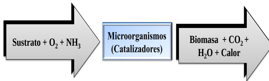
Figura 4.15 Proceso básico de generación de composta. Fuente: Adaptado de Castells, 2012.
