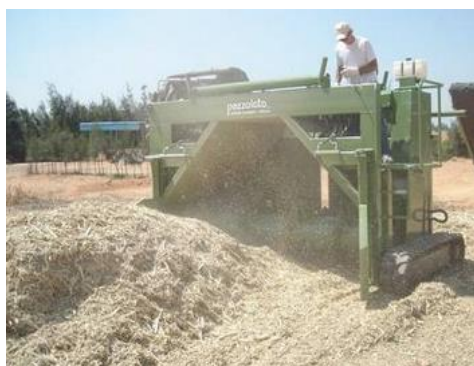
Figura 3. 14 Ejemplos de equipo para airear pilas durante el composteo. Fuente: a) COMPOSTAMEX , 2016; b) PEZZOLATO, 2016; c) RECOVERY. (2016).
