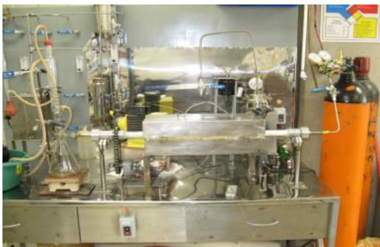
Figura 4. Reactor donde se efectuó la pirólisis.
