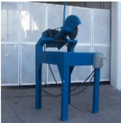
Figura 1. Máquina cortadora manual usada en el proceso anterior de corte de varilla
