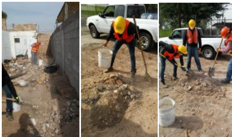
Figura 6. (a) Modificación al método de cuarteo propuesto en la NOM. NMX-AA-015-1985 para RCD en campo.
