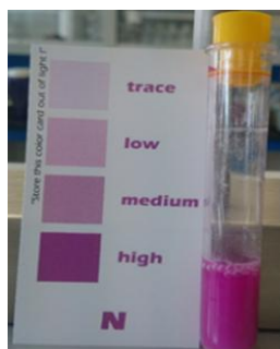
Figura 3. Determinación de nitrógeno mediante kit HANNA CHECKER ®
