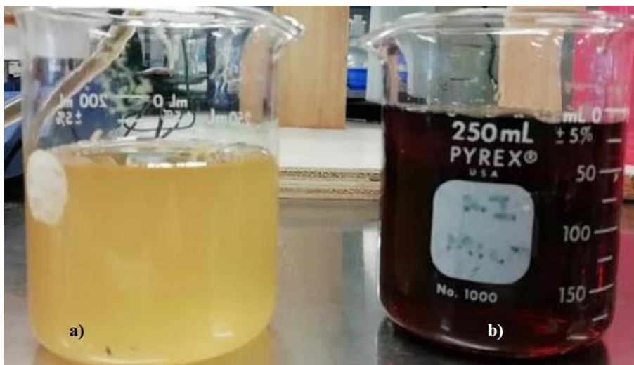
Figura 8. Comparación visual entre el lixiviado crudo y el lixiviado tratado. a) lixiviado tratado en el bioreactor BR3 y b) lixiviado crudo
