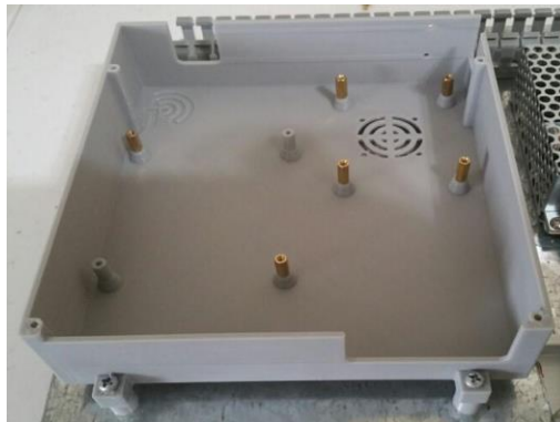
Figura 2. Caja de plástica hecha por una impresora 3D para contener componentes electrónicos.
