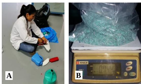
Figura 2. A) Plásticos recuperados del centro de acopio. B) Plástico molido con la criba de 1 mm
