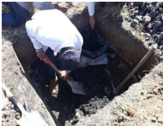
Figura 1. Muestreo de los residuos envejecidos en el relleno sanitario
